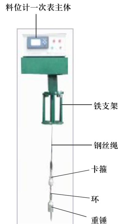
注：接线方法：(控制箱**1- 8**脚接在料位计对应的**1- 8**脚)，(主控箱**9- 10**脚接变送功能**4- 20mA**)，(**11- 12**脚接**220V**电源)
